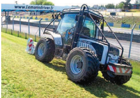
La société utilise des tracteurs Better de 100 ch à quatre roues directrices. Capables d'intervenir dans des pentes de 30°, ces modèles sont munis d'un broyeur frontal à marteaux de 2 m de large.
