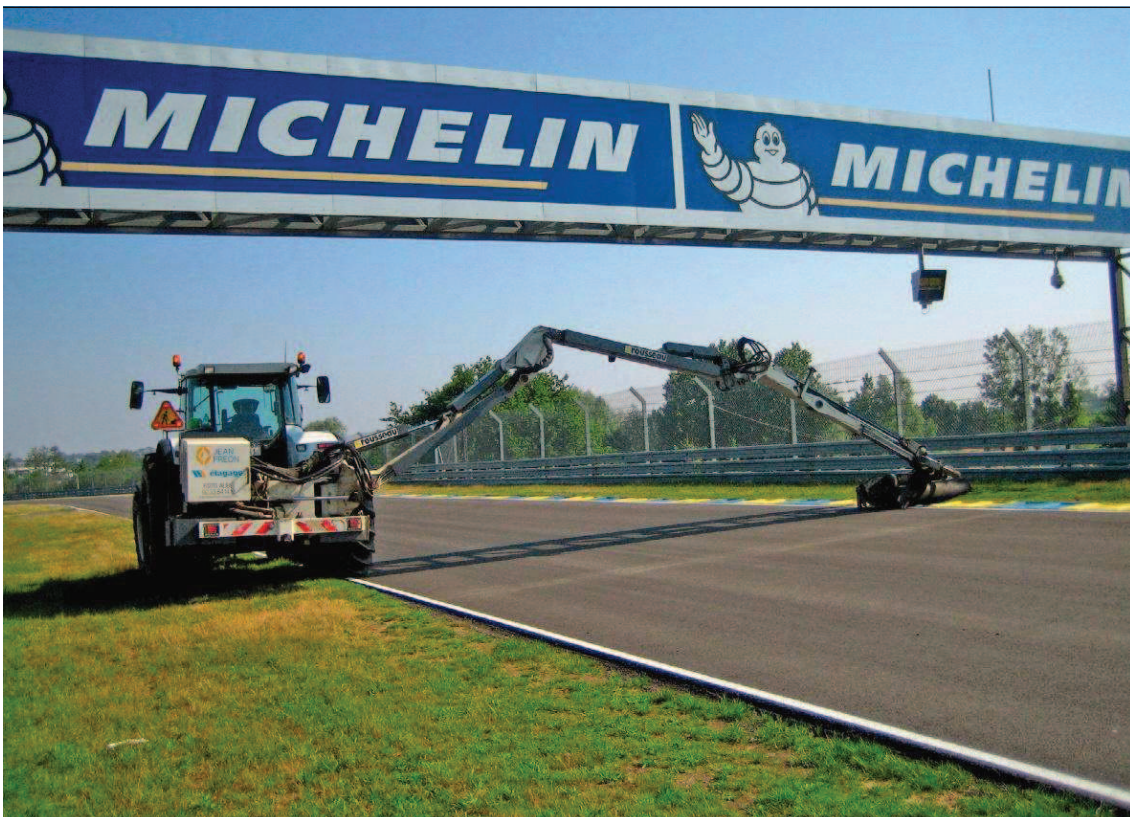
Grâce à cette épareuse Rousseau unique, d'une portée de travail de 12,5 m, l'entreprise effectue des chantiers spécifiques, comme ici sur le circuit des 24 Heures du Mans.
